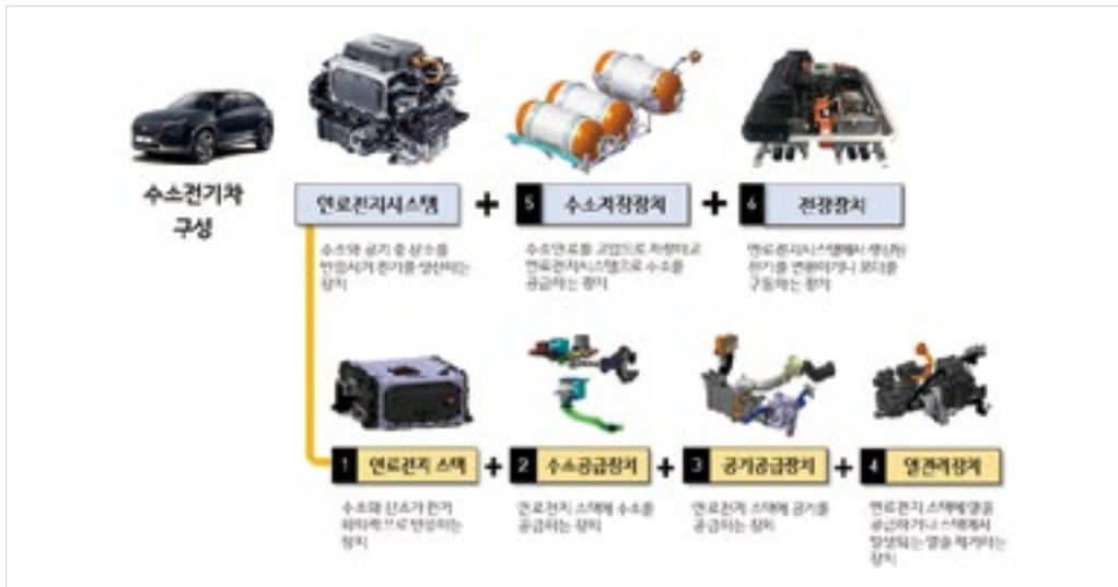
[그림 7] 수소전기차의 시스템 구성
