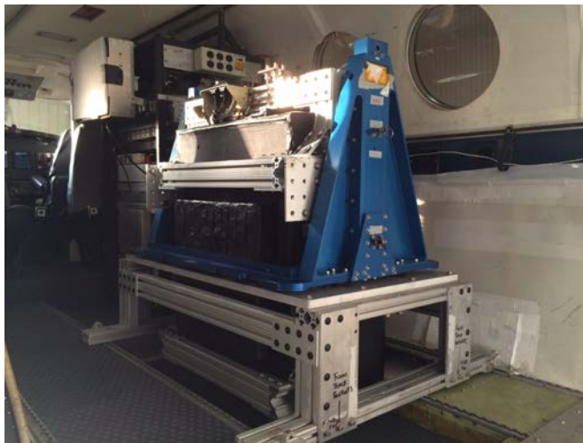
〈그림 8〉 NASA 프로그램으로 Ball Aerospace가 개발한 항공기탑재 대기환경관측 초분광영상기 GeoTASO (출처: espo.nasa.gov)
