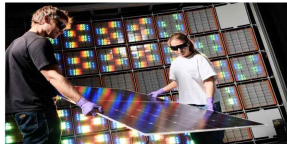
< 독일 프라운호퍼 ISE 연구소에서 개발한 탠덤 모듈 및 효율측정장치 > (출처 : Taiyang News)
