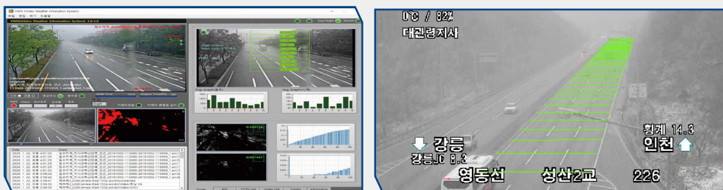
〈그림7〉 우수성과를 통해 도출된 판별 소프트웨어(왼쪽) 및 도로를 이용한 안개 및 시정거리 분석(오른쪽)
