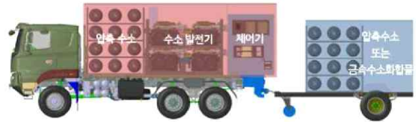
< 이동형 수소 연료발전기 및 수소공급장치 모식도 >
