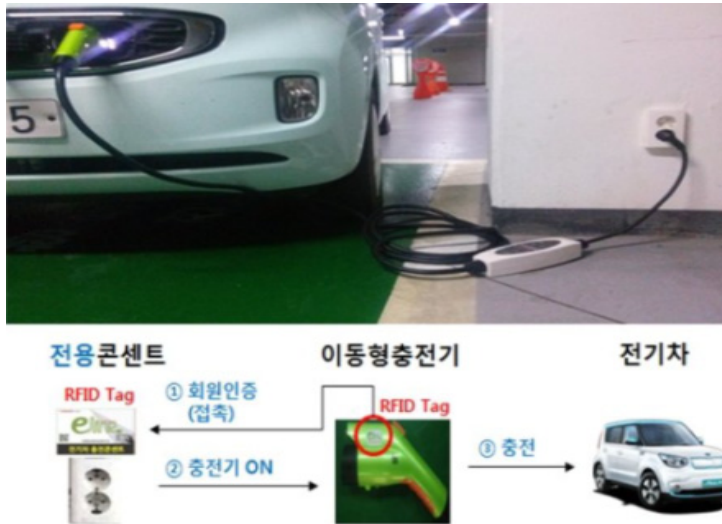
[그림 3-9] 이동형 충전기 이용 사례
