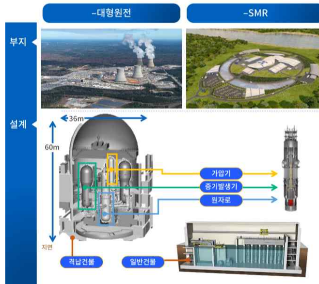
[그림 5-3] 대형 원전과 SMR의 부지 및 설계 차이
